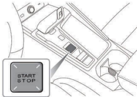
El interruptor de arranque/parada sin llave está ubicado en el panel de molduras de la consola central y pertenece al interruptor de arranque por botón. Para operar el sistema, la llave inteligente debe estar en el auto.
