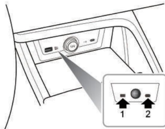
El 12 V enchufe de alimentación de la consola frontal está ubicado en la parte delantera de la consola central. Saque la tapa del enchufe, luego se puede usar como suministro de energía con un máximo de 120W de potencia.
