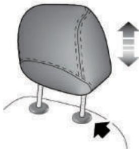
Al ajustar un reposacabezas de una posición baja a una alta, tire del reposacabezas directamente hacia arriba y presiónelo suavemente hacia abajo después de alcanzar la altura deseada para asegurarse de que esté bloqueado en su posición. Para quitar el reposacabezas, presione y mantenga presionado el botón de la guía (como se indica con la flecha) a la izquierda del reposacabezas, luego tire del reposacabezas hacia arriba para sacarlo.
