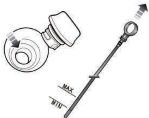
Verifique el nivel de aceite semanalmente y rellene según sea necesario. Idealmente, el nivel de aceite debe verificarse con el motor frío y el auto en reposo sobre terreno nivelado. Si el motor está en marcha y ya está calentándose, espere al menos cinco minutos después de apagar el interruptor de inicio antes de verificar el nivel de aceite.
