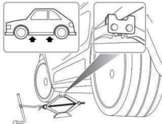
Asegúrese de que la base del gato esté en pleno contacto con el suelo nivelado.
