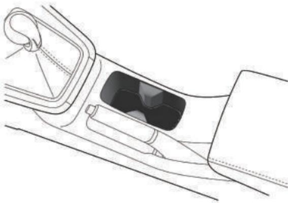
El portavasos de la consola central está situado en el extremo delantero del conjunto del reposabrazos de la consola central y se puede usar para sostener un vaso o una botella de bebida.
