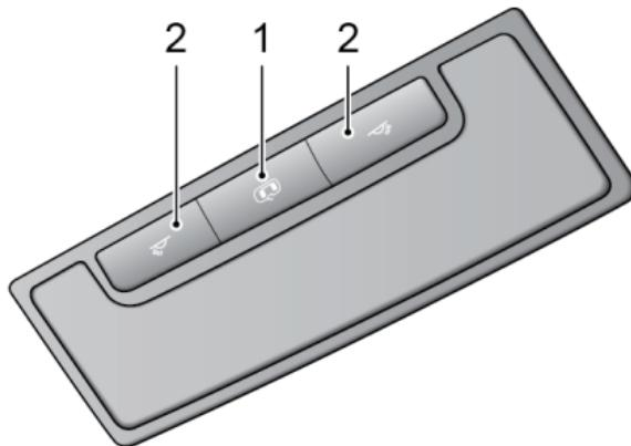
Presione uno de los interruptores ( 2 ) para encender la luz de cortesía correspondiente; presione de nuevo para apagar.
