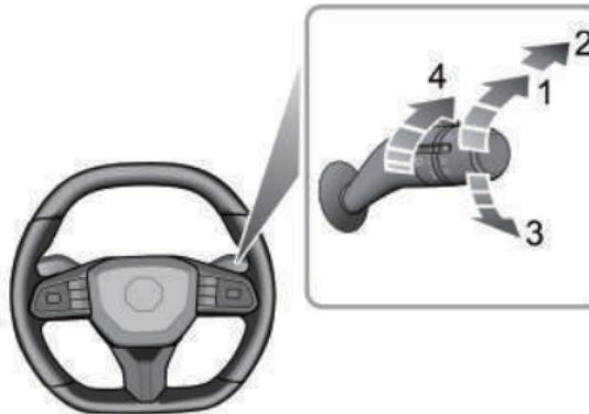
Opera la palanca para seleccionar diferentes modos de limpieza:
