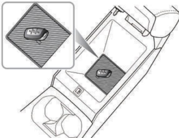
Cuando el vehículo se encuentre en un área con fuerte interferencia de señales de radio, o si la batería de la llave inteligente está baja, por favor inicie el vehículo mediante el procedimiento alternativo de arranque según los siguientes pasos:
