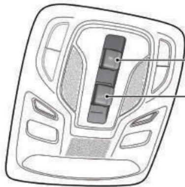
El interruptor del techo solar se encuentra en el techo sobre el parabrisas. Dependiendo de las diferentes configuraciones, los estilos de la consola del techo son diferentes, pero los interruptores del techo solar están en la misma posición. Los métodos de apertura del techo solar se pueden identificar según los símbolos del interruptor. El interruptor 1 se utilizará para operar la cortina del techo solar, y el interruptor 2 se utilizará para operar el vidrio del techo solar.
