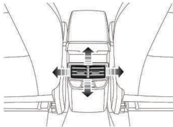
Mueva la perilla en el centro de las rejillas de lado a lado para abrir o cerrar la ventilación. Dirija el flujo de aire moviendo la perilla hacia arriba y abajo, o de lado a lado.
