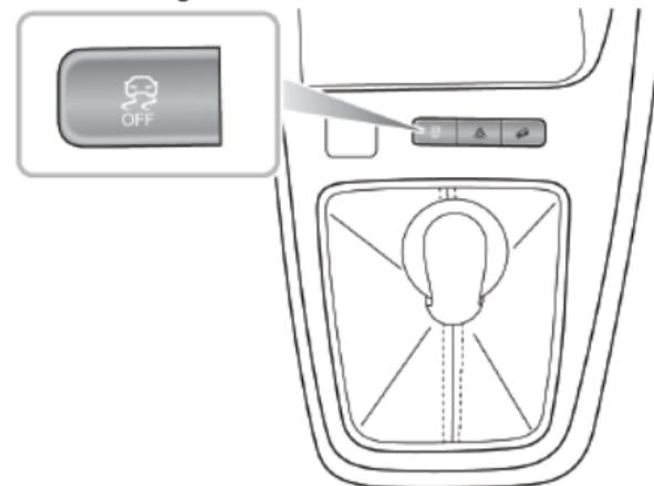
**Nota: Desactivar SCS y TCS no afectará el funcionamiento del ABS. Siempre desactive SCS y TCS cuando conduzca con cadenas para nieve instaladas.**
