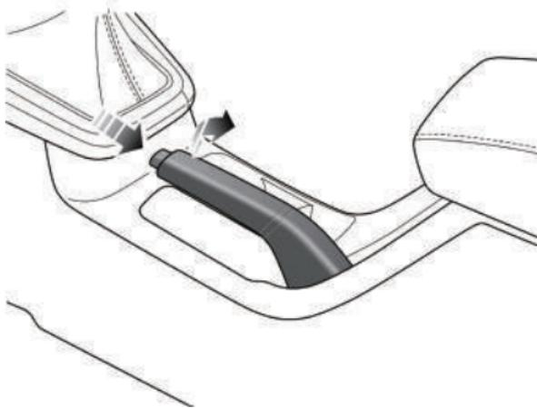
El freno de estacionamiento opera solo en las ruedas traseras. Para aplicar el freno de estacionamiento, tire de la palanca hacia arriba. Mientras esté estacionado, asegúrese de que la palanca del freno de estacionamiento permanezca en estado aplicado.
