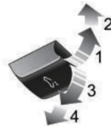
Empuje hacia arriba el interruptor del techo solar hasta la 1<sup>a</sup> posición ( 1 ) y mantenga, el techo solar se abrirá manualmente de manera inclinada. El movimiento del techo solar se puede detener en cualquier momento soltando el interruptor.
