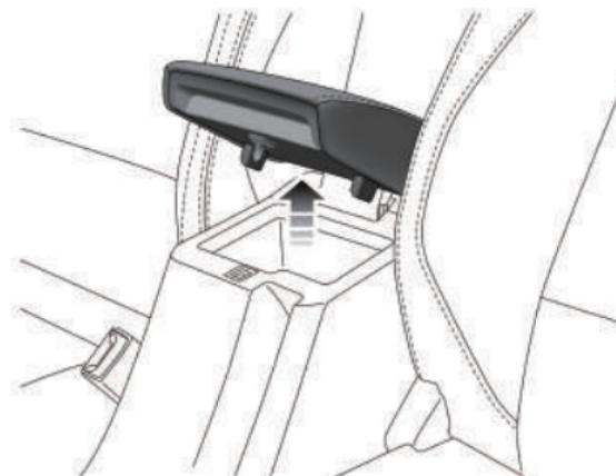
Levante el apoyabrazos de la consola central (como indica la flecha) para abrir la caja de apoyabrazos de la consola central. Presione suavemente hacia abajo la tapa para cerrar la caja de apoyabrazos de la consola central.
