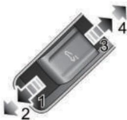
Empuje el interruptor del techo solar hacia atrás a la primera posición ( 3 ) y mantenga presionado, el techo solar se abrirá manualmente deslizando. El movimiento del techo solar se puede detener en cualquier momento soltando el interruptor.
