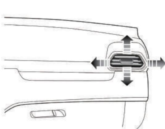
Mueva la perilla en el centro de las rejillas de lado a lado para abrir o cerrar la ventilación. Dirija el flujo de aire moviendo la perilla hacia arriba y abajo, o de lado a lado.
