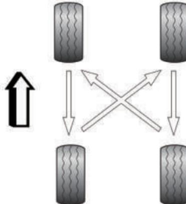
**Nota:** Los neumáticos direccionales (identificados con la flecha en el costado del neumático) NO PUEDEN pasarse de un lado a otro.
