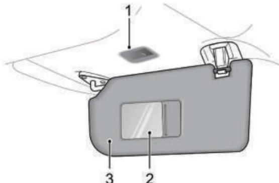
Las viseras están ubicadas en el techo delante de ambos, el conductor y el pasajero delantero ( 3 ). Las viseras están equipadas con espejo de vanidad ( 2 ) \* y luz del espejo de vanidad ( 1 ) \* .
