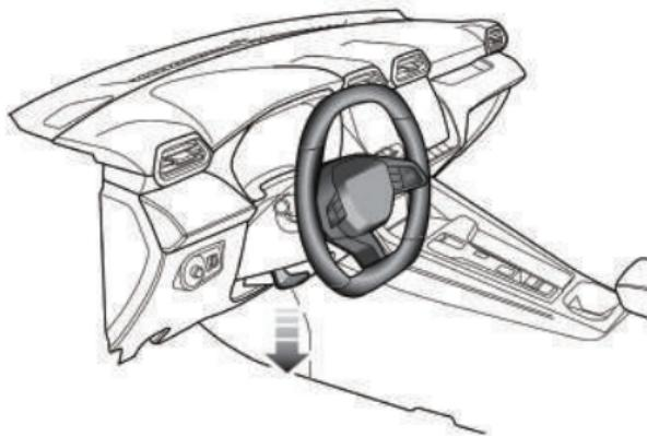
Ajuste la posición del volante para adaptarla a la postura de manejo:
