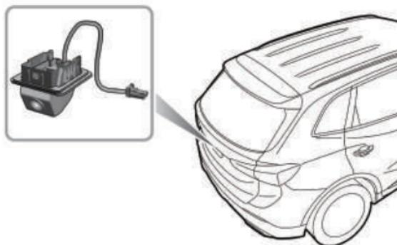
Algunos modelos cuentan con una cámara de estacionamiento trasera instalada entre las luces de la placa de matrícula trasera.
