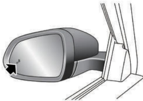
Si hay un riesgo al retroceder, la lámpara de advertencia en el lado correspondiente se encenderá, y se mostrará un triángulo de advertencia en la pantalla de infoentretenimiento.
