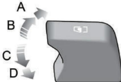
Presiona el interruptor de control de la ventana (1 ~ 4) hacia abajo hasta la 1<sup>a</sup> posición (Posición C) para bajar la ventana, y tira del interruptor hacia arriba hasta la 1<sup>a</sup> posición (Posición B) para subir la ventana. La ventana se detendrá tan pronto como se suelte el interruptor.
