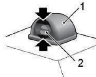
Opera el limpiaparabrisas para rociar agua periódicamente y verificar si las boquillas están limpias y en la dirección correcta. Si la boquilla está obstruida, inserta una aguja o un alambre delgado de metal en el orificio para eliminar la obstrucción.
