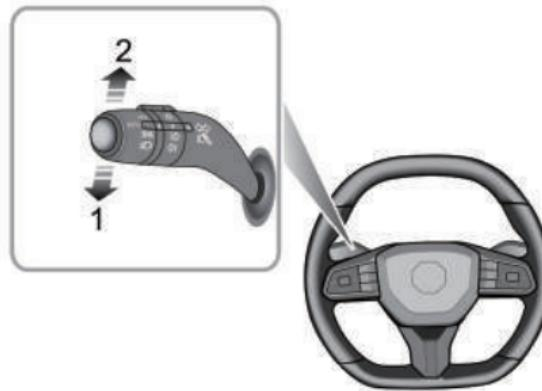
Empuje la palanca de iluminación hacia abajo ( 1 ) para encender la luz de señalización izquierda; empuje la palanca hacia arriba ( 2 ) para encender la luz de señalización derecha. La lámpara indicadora VERDE correspondiente en el panel de instrumentos parpadeará cuando las luces de señalización estén funcionando.
