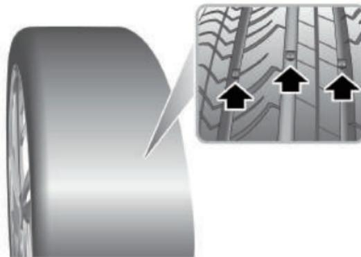
Cuando el rodado se haya desgastado hasta 2,0 mm o menos, los indicadores aparecerán en la superficie del patrón del rodado, lo que producirá un efecto de una banda de goma continua en el ancho del neumático.
