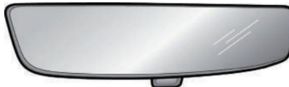
Mueve la palanca en la base del espejo retrovisor interior para cambiar su ángulo, de modo que logres la función antideslumbrante. La visibilidad normal se restaura al volver a tirar de la palanca.
