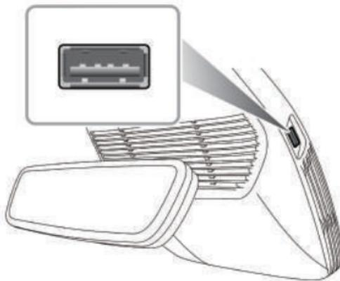
También hay 1 USB puerto equipado en la parte trasera de la consola central para algunos modelos. El puerto USB puede suministrar 5 V de voltaje como interfaz de alimentación. Su corriente máxima de funcionamiento es de 2.4 A.
