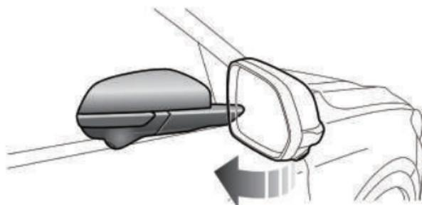
Para los vehículos equipados con la opción de plegado manual del espejo retrovisor exterior, los espejos exteriores solo se pueden plegar hacia atrás manualmente y vuelven a su posición original al empujarlos hacia adelante.
